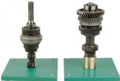
Arbre principal tronqué, monté sur support, pour le démontage et le montage de 2 vitesses chacun, outils inclus.
