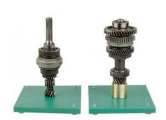
Arbre principal tronqué, monté sur support, pour le démontage et le montage de 2 vitesses chacun, outils inclus. L'unité de synchronisation a été préparée de manière à pouvoir être montée sans extracteur ni presse. Particulièrement adapté à la réalisation d'une procédure de montage. Les vitesses sont faciles à passer.
