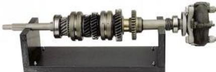
Un arbre principal entier avec arbre d'entraînement a été préparé de manière à pouvoir être démonté et remonté sans presse ni extracteur.
