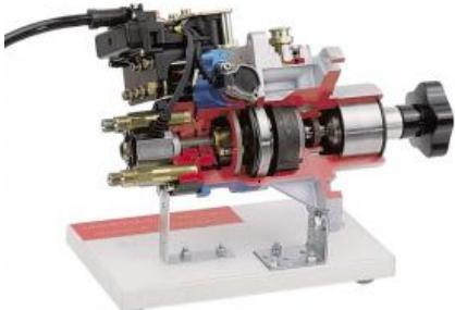
Fonctionnement de la pompe haute pression, distribution, réglage de la pulvérisation et régulation du débit.
