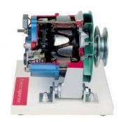
On peut y voir les éléments suivants : Rotor avec enroulements et bagues collectrices Régulateur avec balais de charbon Diodes de puissance et d'excitation Stator avec enroulement statorique
