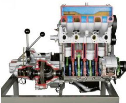
Un moteur original VW-Golf avec embrayage et boîte de vitesses - est monté sur un châssis mobile. À l'aide d'un moteur électrique et d'une batterie 12 V, le moteur et tous les accessoires se déplacent lentement.
