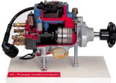
Le régulateur centrifuge est remplacé par un mécanisme de réglage magnétique.
