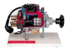
Le régulateur centrifuge est remplacé par un mécanisme de réglage magnétique. Le levier de l'organe de réglage permet de déplacer le curseur de régulation. En outre, il est possible de commander électriquement l'actionneur magnétique pour démontrer la régulation de débit.
