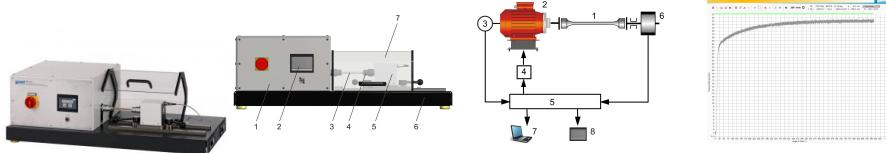
Lessai de torsion fait partie des méthodes dessai destructif, et étudie le comportement plastique des matériaux. Dans la pratique, on se sert de cette méthode dessai pour tester des composants qui sont tordus pendant leur utilisation, comme par exemple les vis, arbres, axes, fils et ressorts.
