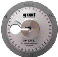
Cet instrument de mesure de l'angle de torsion est un accessoire conçu pour l'appareil dessai WP 500.
