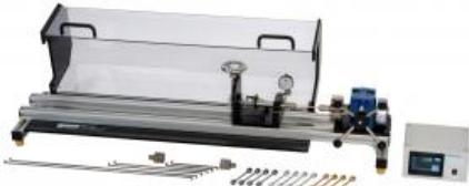
Lessai de torsion fait partie des méthodes dessai destructif, et étudie le comportement plastique des matériaux. Dans la pratique, on se sert de cette méthode dessai pour tester des composants qui sont tordus pendant leur utilisation, comme par exemple les vis, arbres, axes, fils et ressorts.
