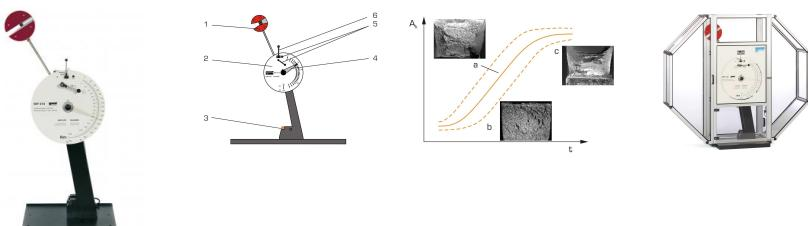
Dans le contrôle qualité industriel, l'essai de résilience est un essai très répandu; il permet de déterminer rapidement et simplement des valeurs caractéristiques pour l'évaluation de matériaux ou de composants. Le banc d'essai WP 410 est un mouton pendule solide suivant la DIN EN ISO 148-1, qui a été conçu pour la réalisation d'essais de résilience Charpy.
