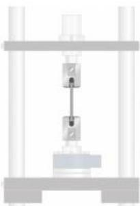
Cet accessoire, conçu pour l'appareil dessai WP 310, permet de réaliser des essais de traction sur des éprouvettes cylindriques.
