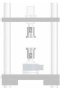
Ce jeu de plaques de compression, disponible en accessoire pour l'appareil dessai WP 310, permet de réaliser des essais de compression.
