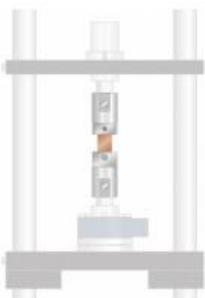
Cet accessoire, conçu pour l'appareil dessai WP 310, permet de réaliser des essais de cisaillement à double section.
