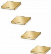
Ce jeu d'échantillons métalliques est disponible comme accessoire pour la machine d'essai universelle WP 300. Les échantillons sont de forme carrée et sont prévus pour la réalisation des essais de dureté suivant Brinell. Le jeu comprend quatre échantillons en laiton (CuZn39Pb3).
