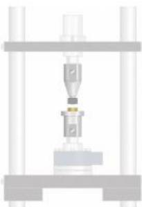
Cet accessoire, conçu pour l'appareil dessai WP 310, permet de réaliser des essais de dureté Brinell. Cette installation dessai est composée dun dispositif avec une bille en acier trempé comme corps déprouvette et dune plaque de compression pour le logement de léprouvette. Ce dispositif est inséré dans la traverse supérieure de l'appareil dessai WP 310 et la plaque de compression dans la traverse inférieure.
