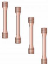
Ce jeu d'éprouvettes de traction est disponible comme accessoire pour la machine d'essai universelle WP 300. Il comprend des échantillons de traction en cuivre (E-Cu).
