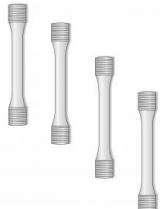
Ce jeu d'éprouvettes est disponible en accessoire pour l'appareil d'essai WP 300.
