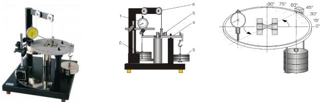
Les hypothèses des contraintes s'appliquent dans le domaine de la résistance des matériaux lorsque des contraintes de comparaison sont calculées pour des contraintes composées inégales.
