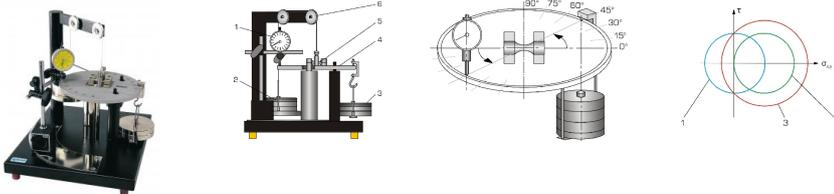
Les hypothèses des contraintes s'appliquent dans le domaine de la résistance des matériaux lorsque des contraintes de comparaison sont calculées pour des contraintes composées inégales.
