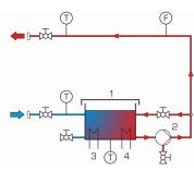
La fonction principale du WL 312.10 est de fournir un circuit d'eau chaude pour les essais dans le WL 312 et le WL 315C.
