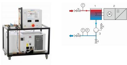
La fonction principale du WL 312.11 est de fournir un circuit deau froide pour les essais dans le WL 312 et le WL 315C. L'alimentation en eau froide permet de assurer un bon fonctionnement lorsque la température ambiante et celle de leau sont élevées.
