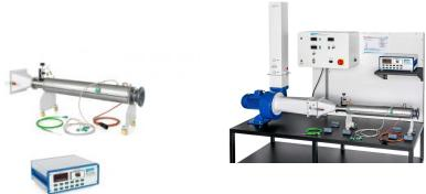
L'accessoire WL 314.03 permet d'étendre les possibilités d'essai du WL 314 à la thématique: transfert de chaleur convectif à l'intérieur d'un tube.
