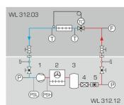
La fonction principale du WL 312.12 est de fournir de l'agent réfrigérant comprimé et ensuite condensé pour les essais dans le WL 312.
