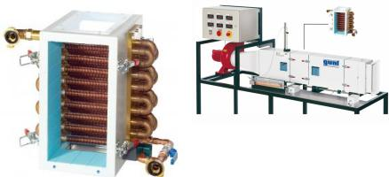
Les échangeurs de chaleur avec tubes à ailettes sont utilisés pour obtenir un transfert de chaleur optimal entre des fluides gazeux et des liquides, à condition que les fluides ne soient pas souillés.
