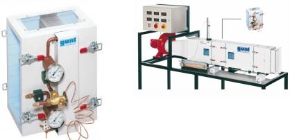
L'échangeur de chaleur WL 312.03 permet de réaliser des études sur un évaporateur de réfrigérant dans le banc d'essai WL 312.
