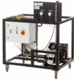
La fonction principale du WL 312.12 est de fournir de l'agent réfrigérant comprimé et ensuite condensé pour les essais dans le WL 312.
