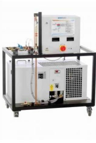
La fonction principale du WL 312.11 est de fournir un circuit deau froide pour les essais dans le WL 312 et le WL 315C. L'alimentation en eau froide permet de assurer un bon fonctionnement lorsque la température ambiante et celle de leau sont élevées.
