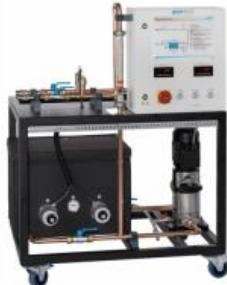
La fonction principale du WL 312.10 est de fournir un circuit d'eau chaude pour les essais dans le WL 312 et le WL 315C.
