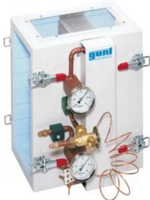
L'échangeur de chaleur WL 312.03 permet de réaliser des études sur un évaporateur de réfrigérant dans le banc d'essai WL 312.
