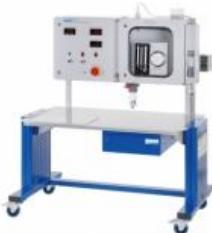
**Chambre climatique à humidité réglable; comparaison de quatre procédés de mesure**
