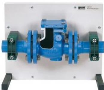
Véritable clapet de retenue transformé en modèle en coupe.
