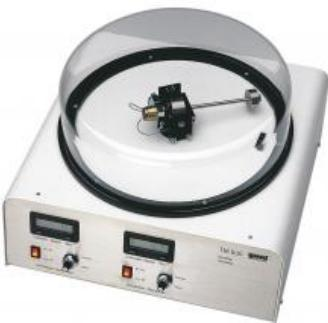
**TM 630 Gyroscope, vérification expérimentale des principes du gyroscope (Réf. 040.63000)**
