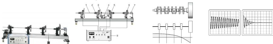
Des vibrations de torsion sont souvent observées dans les systèmes d'entraînement.
