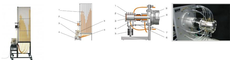
Sur les paliers lisses hydrodynamiques, le palier et le coussinet de palier sont séparés l'un de l'autre par un film lubrifiant pendant le fonctionnement.
