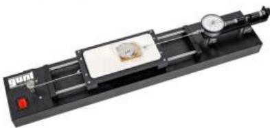
Les apparitions de frottement jouent un rôle essentiel en mécanique. Le frottement statique doit suffire à fixer des pièces entre elles, par ex. freins de stationnement, filetage irréversible ou liaisons par friction.
