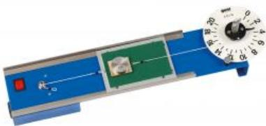
L'appareil permet de effectuer des essais de base sur le frottement d'adhérence et le frottement de glissement. Deux corps solides sont déplacés l'un par rapport à l'autre de manière uniforme.
