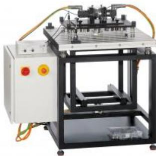
**TM 182 Vibrations sur les fondations de machines, absorbions des vibrations (Réf. 040.18200)**
