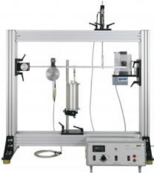
**Expériences de base sur la science des vibrations mécaniques**
