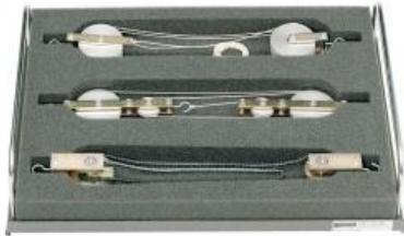
Le jeu complémentaire TM 110.02 élargit la gamme des essais du TM 110 avec le sujet comparaison de différentes poules et de leurs effets en tant que "machines simples".
