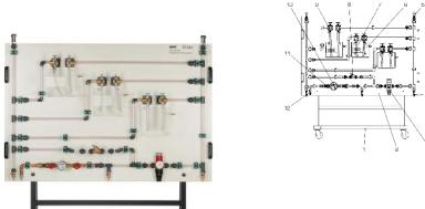
Le banc d'essai présente un système ouvert de conduites qui simule une installation domestique d'eau potable avec 4 hauteurs différentes.
