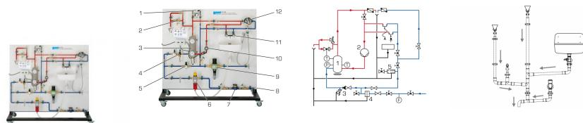
Sur le panneau de l'appareil d'essai est montée une installation d'eau potable comparable aux installations domestiques habituelles.
