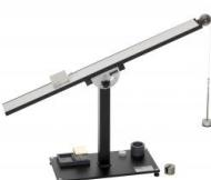
Les essais de frottement sur un plan incliné aident les élèves à comprendre les fondements du frottement mécanique.
