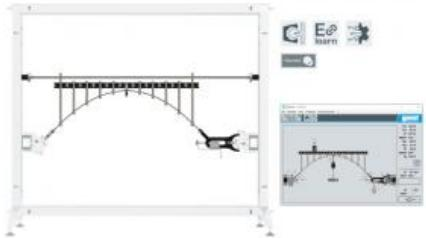
Un pont à arc se compose d'un arc qui soutient le pont par le bas, soit le maintient par le haut.
