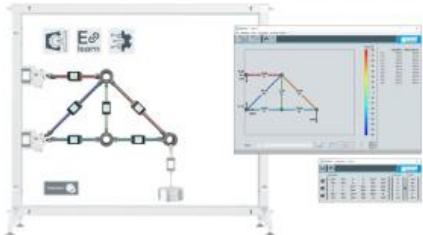
Les treillis sont des constructions à barres dans lesquelles les barres sont uniquement sollicitées en pression ou en traction, mais pas en flexion.
