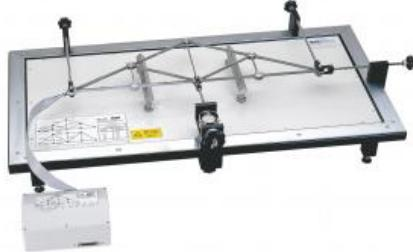
Comme construction légère avec rigidité élevée, les treillis trouvent principalement leur application dans la construction de halles, de ponts, de grue et de pylône.
