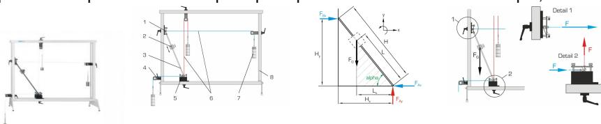
En mécanique appliquée, le principe de la "coupe" ou principe de la "coupe", permet de visualiser les forces et moments qui sexercent sur un corps.
