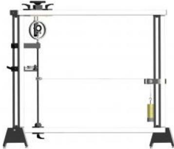
Du fait de leur fonction, les composants longs et étroits tels que barres, poutres, tubulures etc. sont souvent soumis à une contrainte de compression sous l'effet de forces s'exerçant parallèlement à leur axe.
