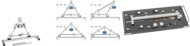
Le FL 111 représente un treillis idéal. Dans le système plan, les barres sont soumises uniquement à la compression et à la traction.
