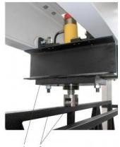
Cet accessoire pour SE 100 comprend deux dispositifs de charge à entraînement hydraulique.
