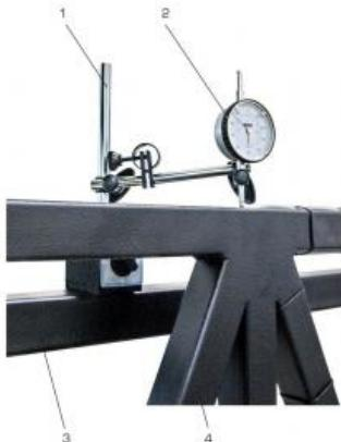
Ce jeu de comparateurs mécaniques à cadran permet de mesurer précisément les distances mécaniques.
