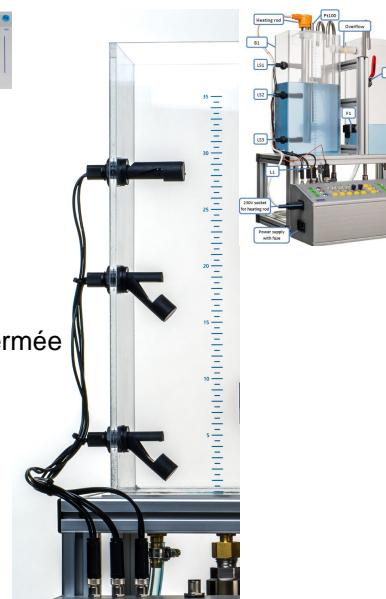
LC2030 Système de régulation de niveau, débit pour API ou régulateur externe, complet,
