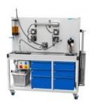
Le banc RT 700 est une station dexercices complètement équipée avec tous les composants et moyens auxiliaires nécessaires pour réaliser un cours complet sur les principes de base des commandes hydrauliques.
