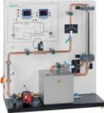
**Déconnexion possible du régulateur interne pour utiliser un régulateur externe, mesure par fiche 4mm**
