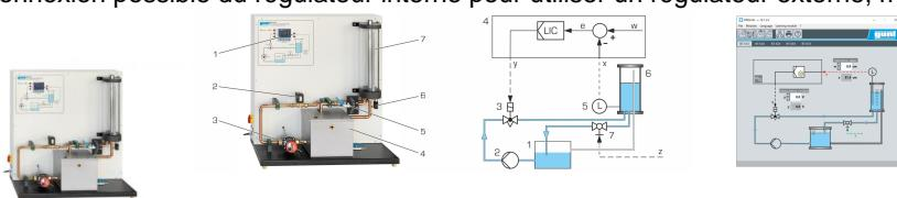
L'appareil d'essai constitue une introduction expérimentale étendue aux principes de base de la technique de régulation à l'exemple d'une régulation de niveau.
