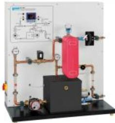
L'appareil d'essai constitue une introduction expérimentale étendue aux principes de base de la technique de régulation à l'exemple d'une régulation de température.
